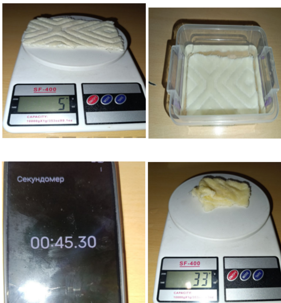
Рисунок 3. Определение общей водопоглощающей способности разработанной ткани: а – сухой образец массой 5 г; б – процесс насыщения водой; в – продолжительность испытания (45 с); г – масса образца после испытания (33 г)
